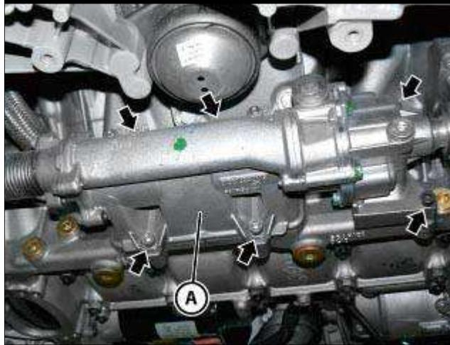
● 松开指示的将机油泵 (A) 紧固至曲轴箱上的六个螺钉。
