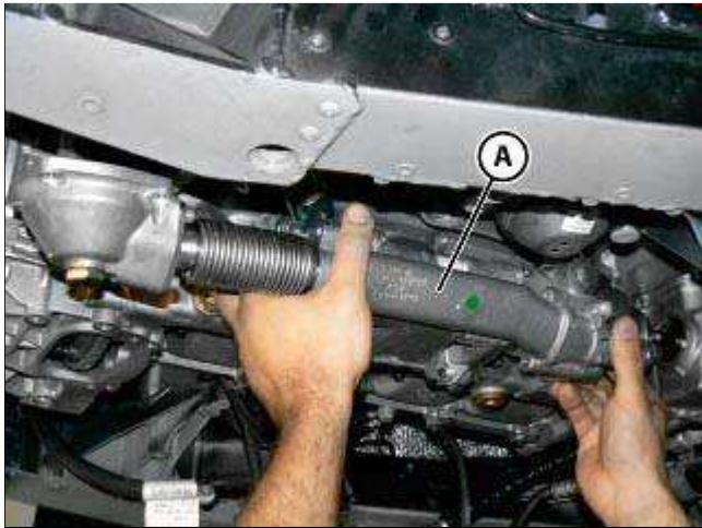
● 从发动机上拆下机油泵 (A) 及下部壳体。
