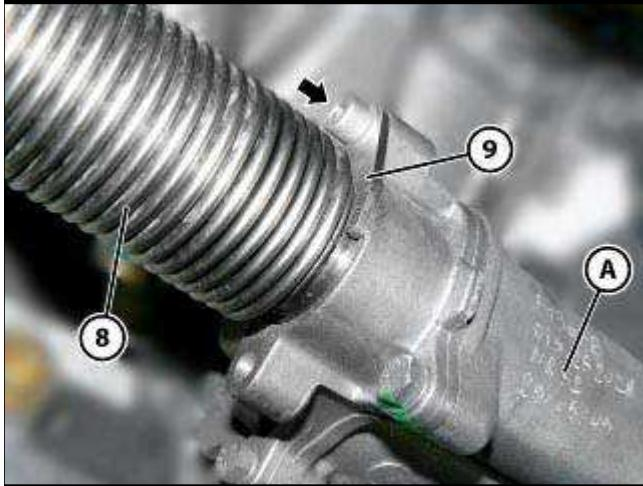
● 必要时，在工作台上，松开指示的螺钉，将机油泵 (A) 从法兰 (8) 分离，取出固定叉 (9)。
