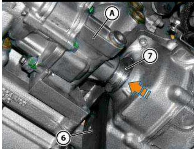
● 支撑机油泵的重量，并用合适的保护工具 (6) 将其撬起，向后垂直移动机油泵 (A)，以便将管接头衬套 (7) 从曲轴箱分离。
